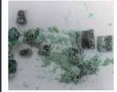
**2** AFTER PRE-CUTTING IN A **CUTTING MILL SM 300**
