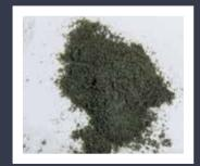
**3** PULVERIZATION IN THE CRYOMILL TO 200 µM
